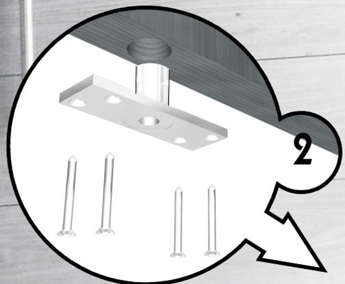
Fixe a chapa inferior porta. Utilizar broca Ø23mm com profundidade 40mm.
